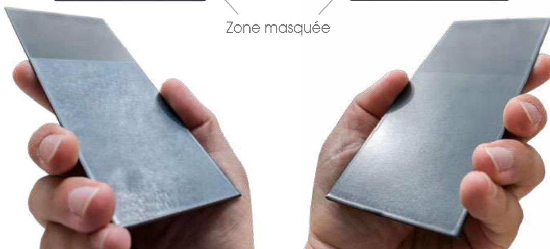
\*Test QUVB 313 (norme 4892-3). L'enceinte de vieillissement accéléré, reproduit artificiellement le spectre solaire complet. Elle simule, en quelques heures ou semaines, les détériorations et les dommages provoqués par l'irradiation solaire et les intempéries en extérieur sur plusieurs années - \*\* Par rapport à la perte de brillance d'un laquage Qualicoat Classe 1
