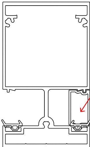
Les chevrons puits de lumière sont équipés d'un obturateur en partie haute
